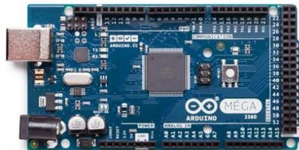
**Fig. 4: Arduino MEGA 2560**
